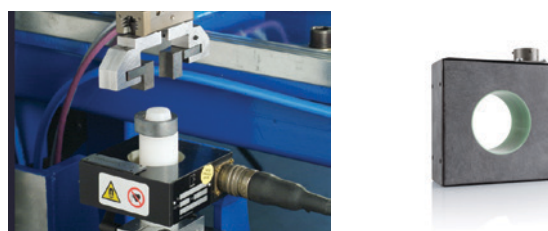
Abbildung 3: Gefügeprüfung mit umfassender Prüfspule
