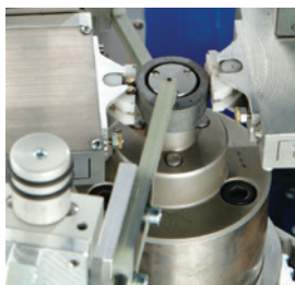
Abbildung 2: Rissprüfung an Nocken mit zwei Prüfsonden auf der Lauffläche und jeweils einer Prüfsonde auf jeder Stirnseite
